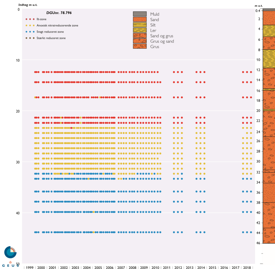
Figur 40. Kasted nordvest for Århus, DGU nr. 78.796, med redoxzoner for perioden 1999-2018. Grundvandsspejl i ca. 9 m u.t. Det geologiske profil er vist længst til højre på figuren.
