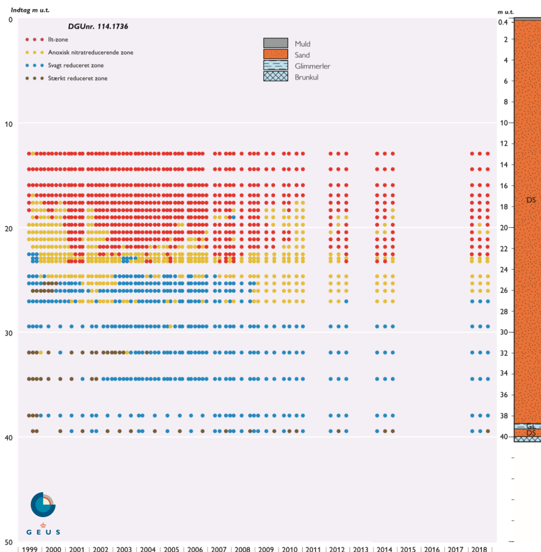
Figur 41. Grindsted i Midtjylland, DGU nr. 114.1736 med redoxzoner for perioden 1999-2018. Grundvandsspejlet er beliggende i ca. 2 m u.t. Det geologiske profil er vist længst til højre på figuren.
